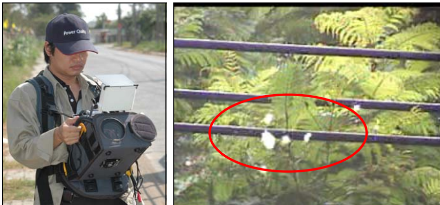
รูปที่ 10 เครื่องตรวจหา Partial Discharge ชนิดภาพ (ซ้าย)
