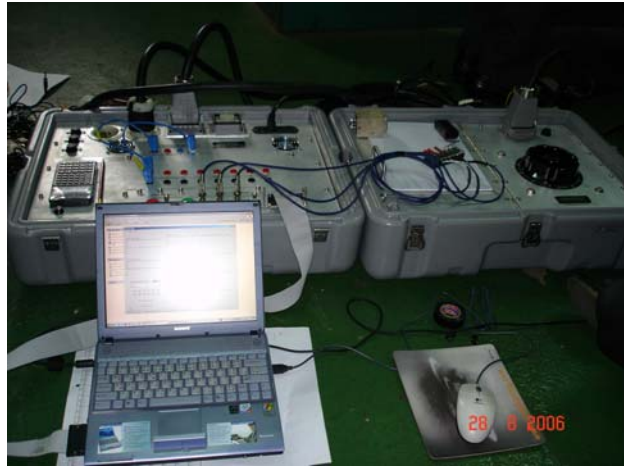
รูปที่ 4 เครื่องกำเนิดแรงดันไฟฟ้าตกชั่วขณะ (Sag Generator)
